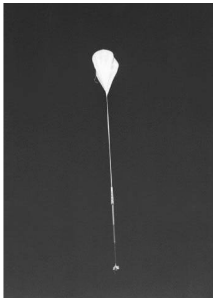
36. ábra: Egy csillagászati műszereket hordozó magaslégköri ballon képe
