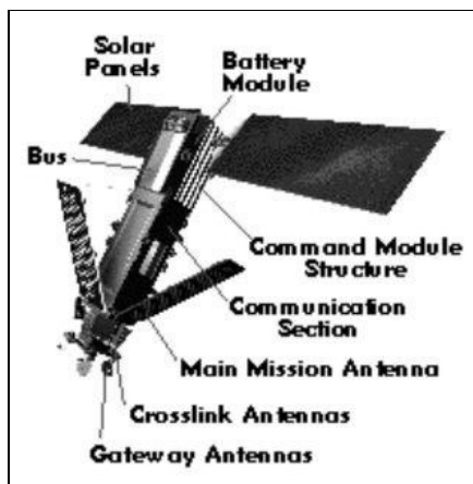
38. ábra: Az Iridium „ármádia” egyik tagjának fényképe – az erős felfényléseket eredményező MMA antennák és napelemtáblák a jobb oldali magyarázó ábrán szemléltethetők meg jobban
